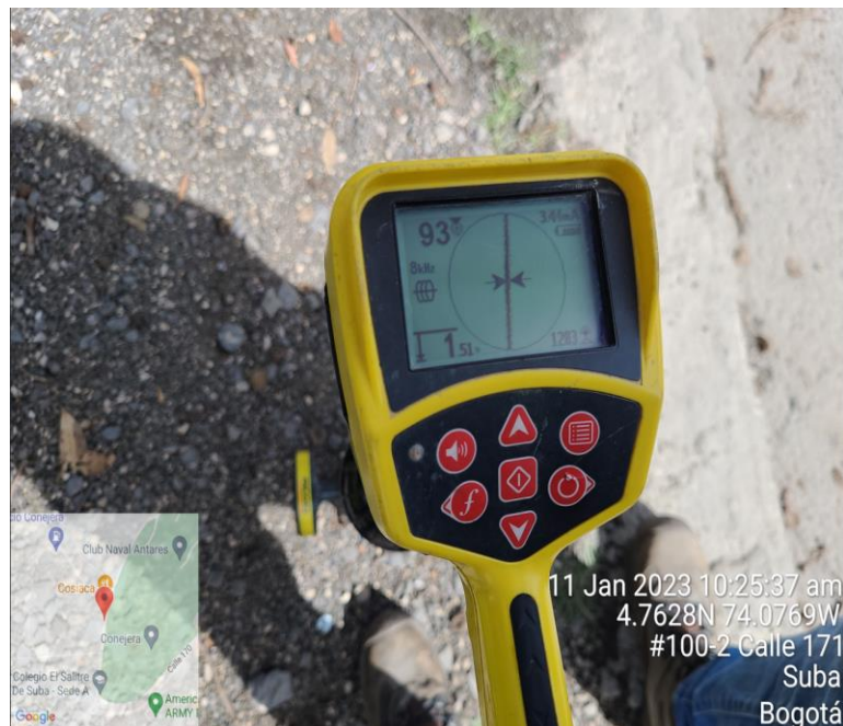
Fotografía 4. Levantamiento de información de la tubería de 14" de la red de VANTI, con equipo de detección de VANTI.
